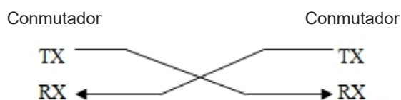
Figure 7-4 Conexión de los cables de fibra óptica
