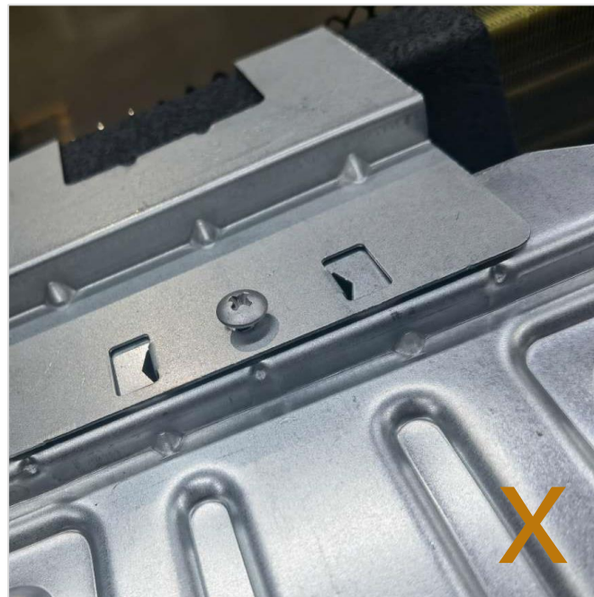
Tornillo mal fijado
