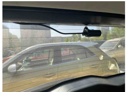
Figura 11, Colocación interior de la cámara trasera en el parabrisas trasero (Opción 2)
